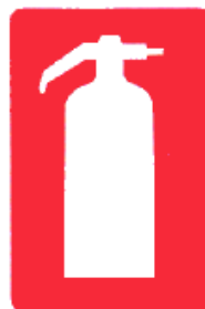
Figura 6.8 - Extintor de incêndio
