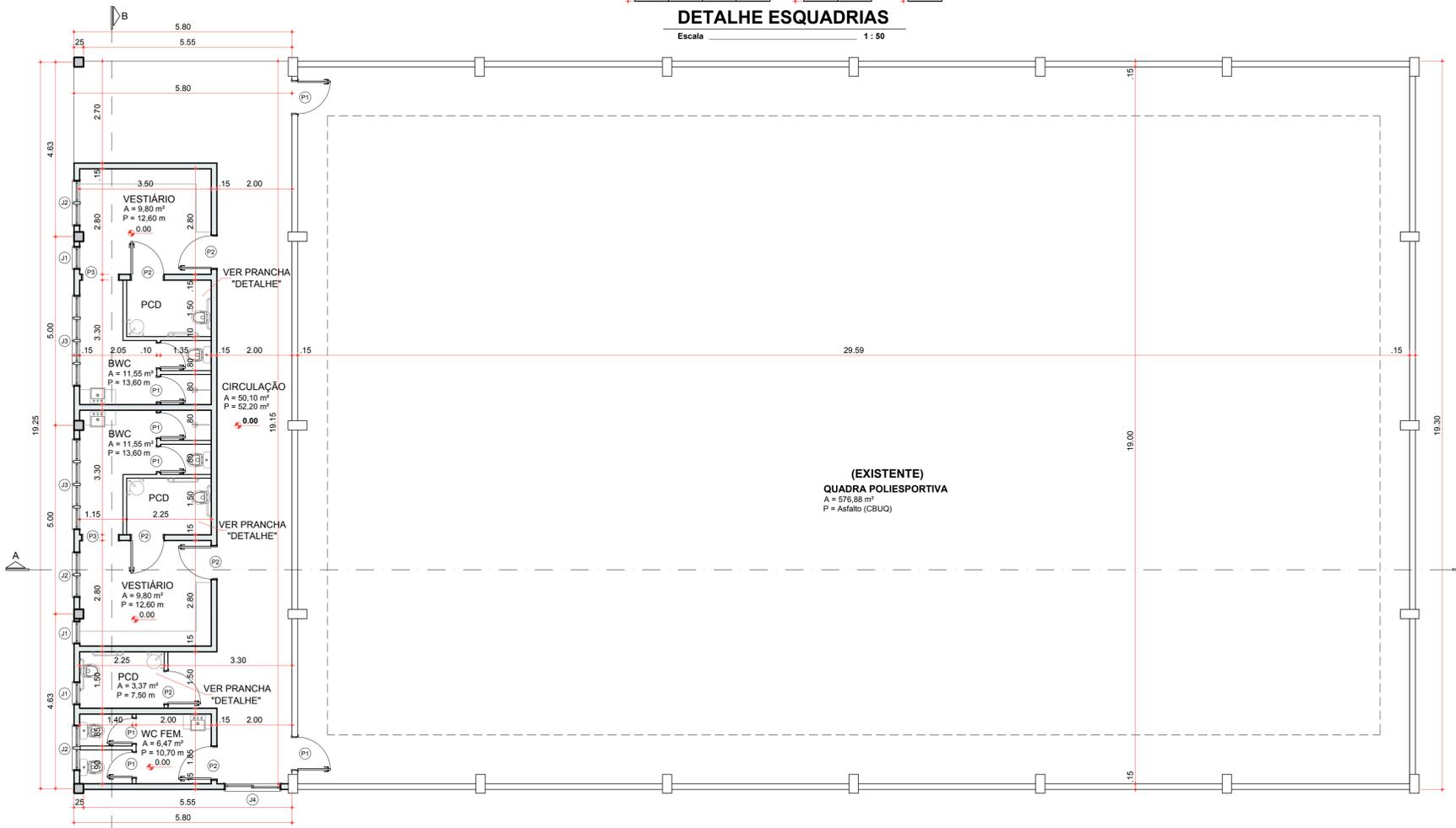
ÁREA EXISTENTE = 576,90 m<sup>2</sup>    ÁREA DE AMPLIAÇÃO = 111,94 m<sup>2</sup>
